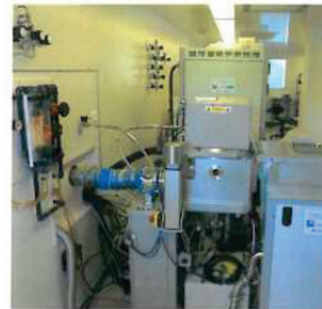
Figure 11 : Bâti de PECVD
